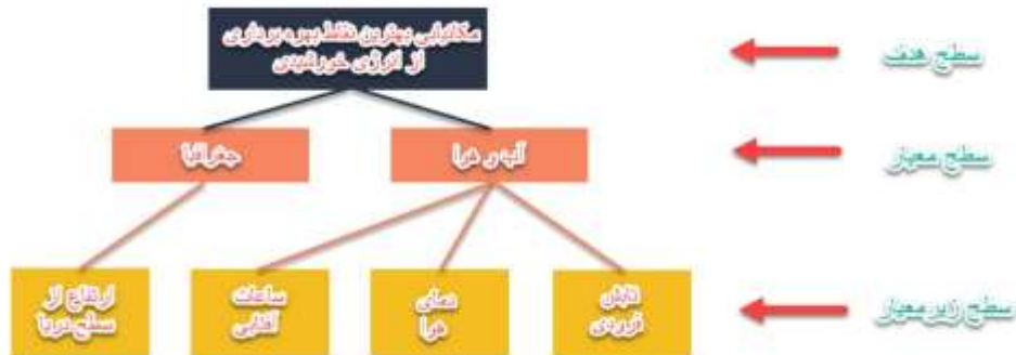
شکل ۴: ساختار تصمیم‌گیری سلسله‌مراتبی برای مکانیابی بهترین نقاط بهره‌برداری از نیروگاه‌های فتوولتائیک
